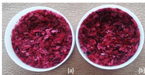
Figura 15. Flocos de jabuticaba obtidos por drum drying com amido de milho (a) e fécula de mandioca (b)
