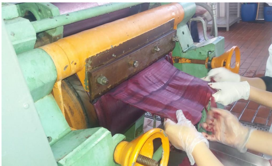
Figura 13. Filme seco de polpa de jabuticaba obtido no drum drying
