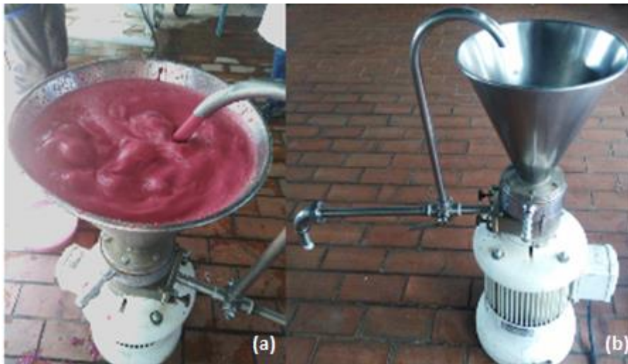
Figura 11. Homogeneização da polpa com os coadjuvantes (a) e moinho coloidal (b)
