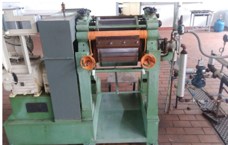
Figura 12. Drum dryer da planta de desidratados do FRUTHOTEC/ITAL
